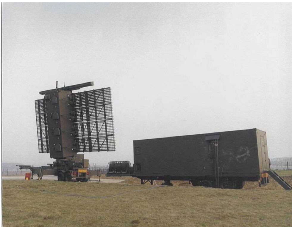
Martello-radar og elektronikcontainer opstillet til afprøvning i England. (Foto: RHBOR).
