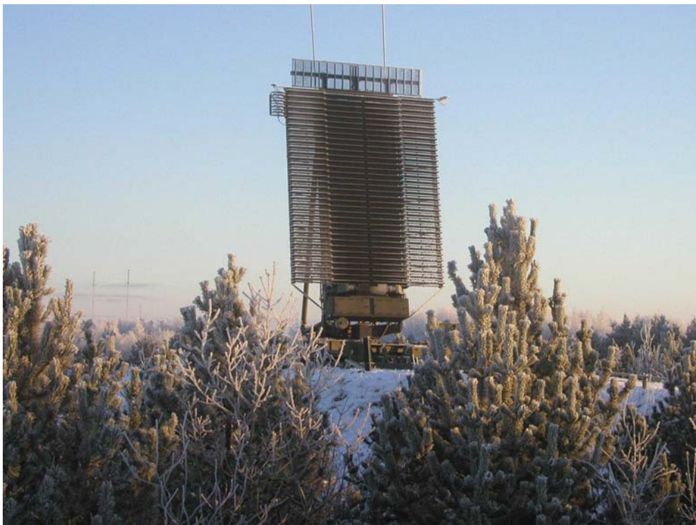
AN/TPS-77 under afprøvning på Flyvestation Karup i februar 2007. (Foto: MACC, Flyvestation Karup).
